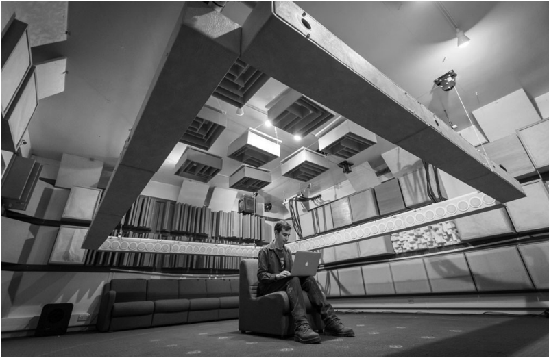
Şekil 6. Salford Üniversitesi dinleme odasında kurulu Wave Field Synthesis sistemi
