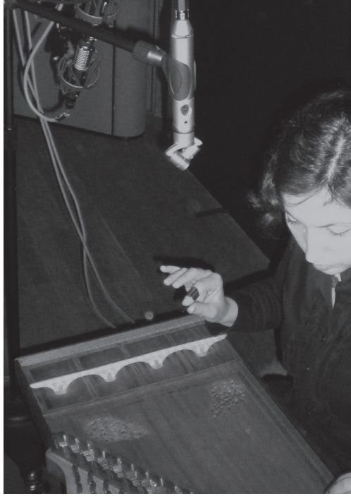
Şekil 9. Rode NT-4 stereo kondensör mikrofon ile kanunun üstünden XY tekniği ile kayıt
